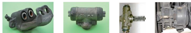
各種ゴム部品類の劣化・膨潤からシール性が失われ、倍力機構が働かず停止距離が長くなる。またブレーキの引きずりを起こし、最悪、車両火災に至る可能性があります。
